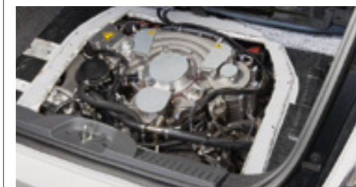
Durch die kompakte Bauweise findet der REX in der Reserveradmulde Platz
