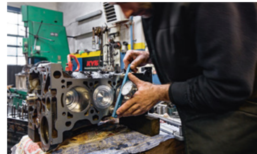
Kontrolle des Kolbenüberstands
