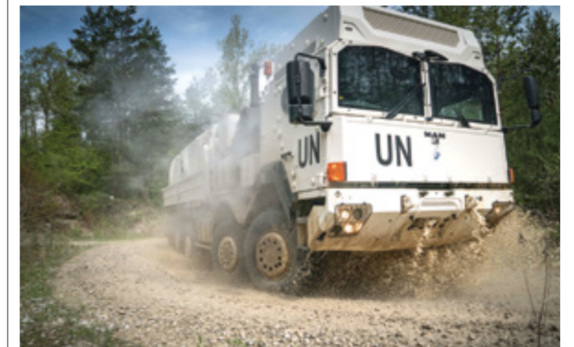
Modulare und integrierte Panzerungen für Fahrerkabinen schützen Fahrzeugbesetzungen gegen Ballistik, Minen und Sprengfallen (IEDs)
