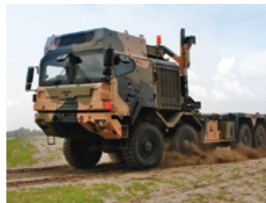
Hochmobiler Truck HX 8x8 mit integrierter gepanzerter Fahrerkabine und integriertem Hakenladesystem
