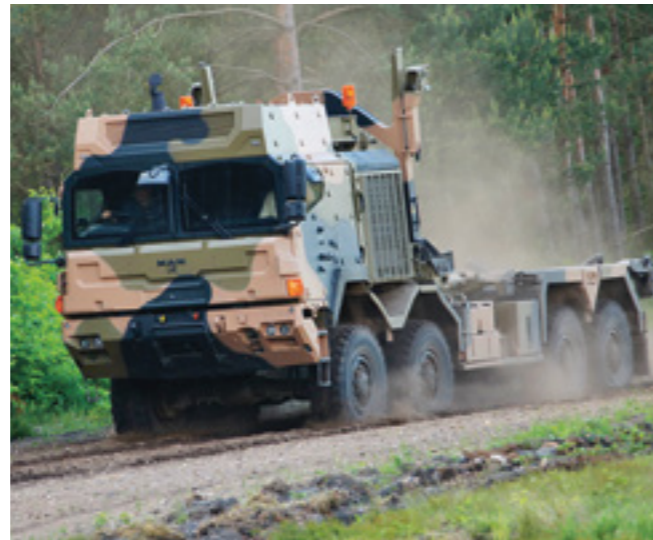
Hochmobiler Truck HX 8x8 mit integrierter gepanzelter Fahrerkabine und integriertem Hakenladesystem
