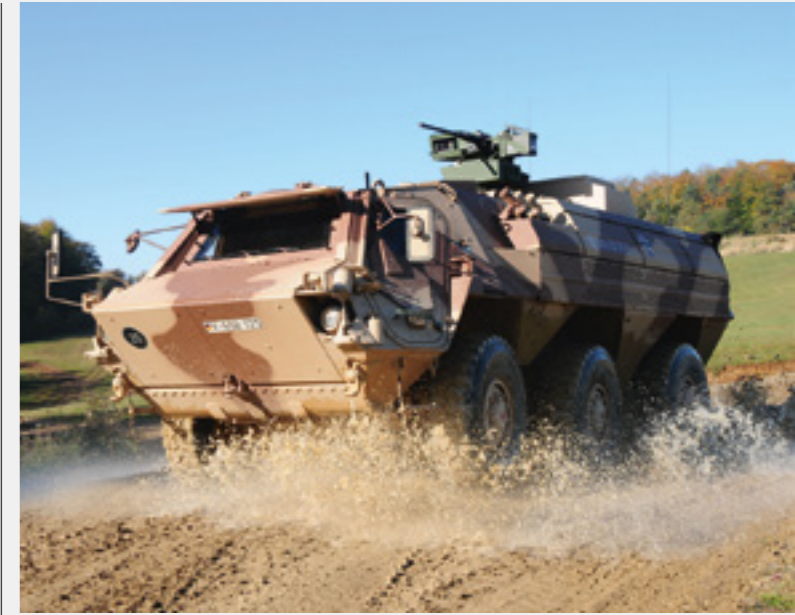
Transportpanzer Fuchs 1A8 mit einer Waffenstation des Typs FLW 200 im Übungsgelände
