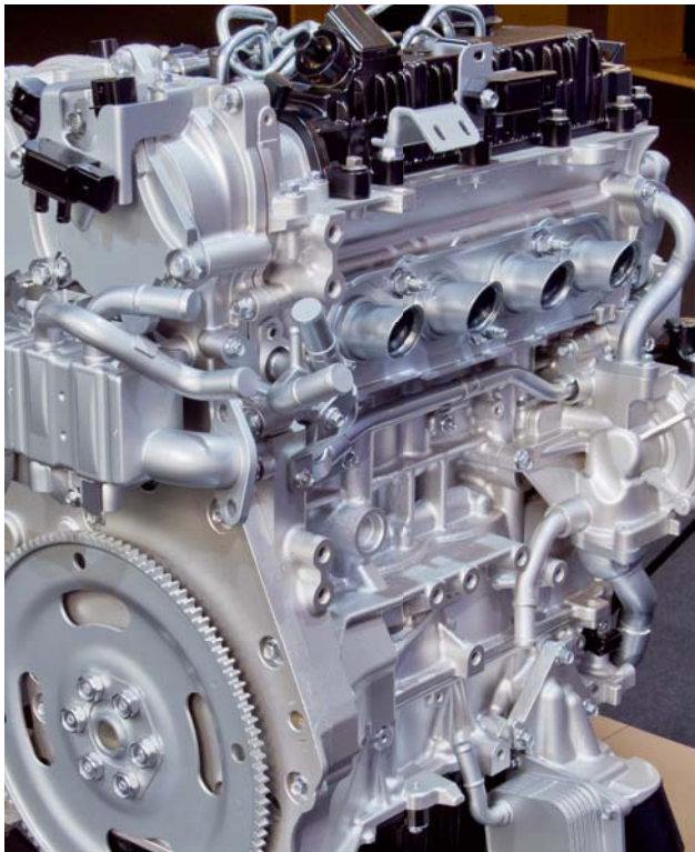
Der SKYACTIV-X-Motor von Mazda stellt durch das SPCCI-Brennverfahren eine echte Innovation dar.
