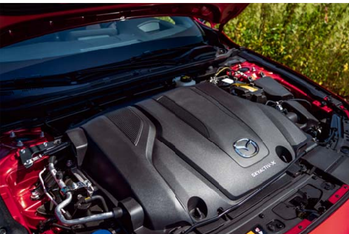
Der SKYACTIV-X-Motor von Mazda stellt durch das SPCCI-Brennverfahren eine echte Innovation dar.
