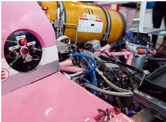
Der Tank kann in drei Minuten mit sechs Kilogramm Wasserstoff befüllt werden.
