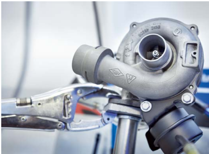
Der Ablauf der Instandsetzung eines Turboladers besteht aus insgesamt 15 Arbeitsschritten. Dies beinhaltet neben diversen Sichtinspektionen und Kontrollen unter anderem die Stationen Demontage, Reinigen und Entfetten, Richten, Montage unter Verwendung von Originalteilen, Wuchten, finale Montage, Kontrolle auf dem Strömungsprüfstand sowie die Endkontrolle und Verpackung.
