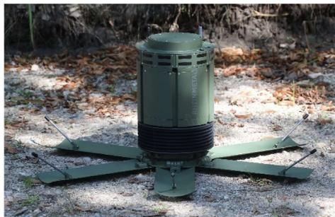
Die rund 25 Kilo schwere ADW misst 234 Millimeter im Durchmesser und hat ein abschussgehärtetes Design. Sie lässt sich von Hand, von Logistikfahrzeugen, von Minenwerfern verlegen oder auch durch die Raketenartillerie verbringen. Dank der vernetzten Kommunikation kann sie aktiviert, deaktiviert oder reaktiviert werden und in ihrer Programmierung geändert werden, so dass sie nur für feindliche Kräfte eine Sperre darstellt.
