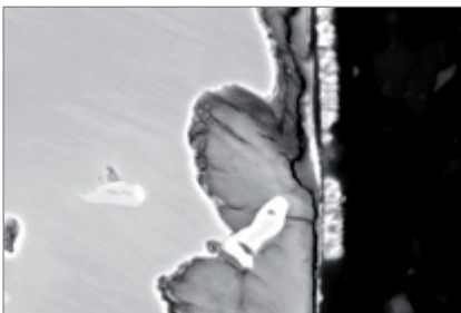
Abb. 7: Korrosionsverhalten von Gbz12 (CC483K) in Salzwasser bei Raumtemperatur über 168 Stunden
