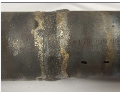
Abb. 1: Lotnaht zwischen zwei EC7 Werkstücken
