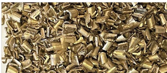
Abb. 5: Rg7 (CC493K) Span bei industrieller Verarbeitung
