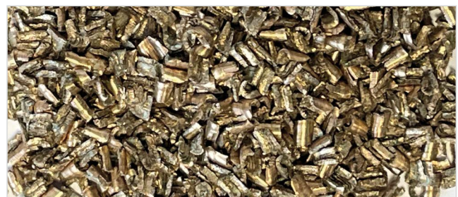
Abb. 6: EC7 Span bei industrieller Verarbeitung
